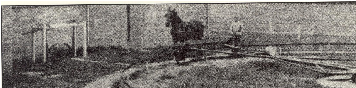
Professor Vissers hestegang til trækprøver (bomlængde 8 m.). En dansk hestegang var lig den her, men med trækbom på 2-3 m.
